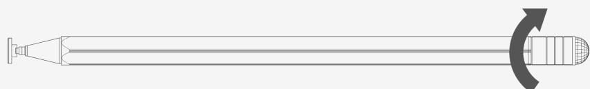
Для защиты точного наконечника стилуса при транспортировке задвиньте его внутрь корпуса, повернув нижнюю часть стилуса против часовой стрелки .
